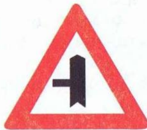
К главной дороге примыкает второстепенная дорога слева
